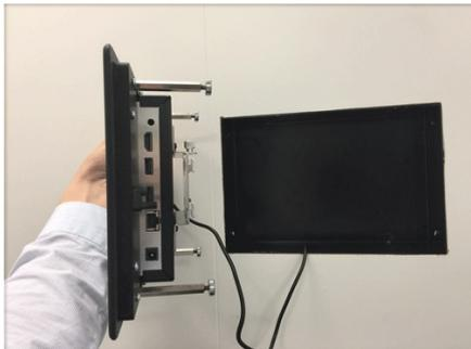
Schritt 1: Montage der Magnete auf Standard PriControl-Panel.
